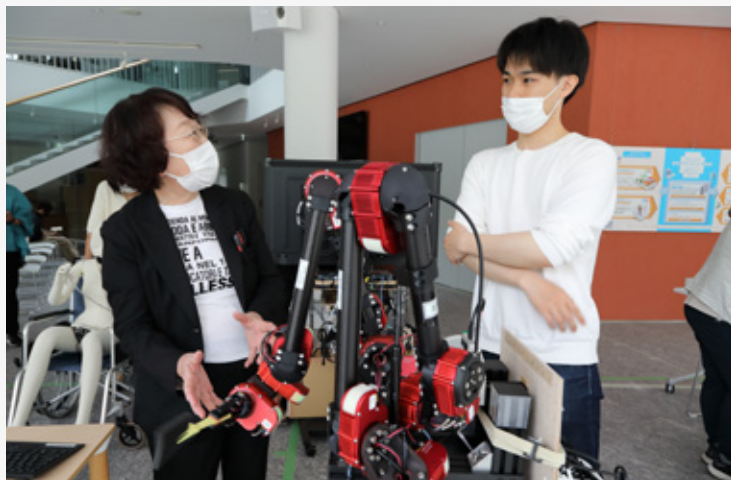
食べ物の形や大きさを認識して口元に運ぶ開発段階のロボット。両腕 14 関節の駆動制御によりフォークやスプーンを使って食べ物を運ぶ。
