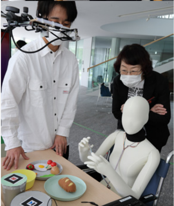
食器の位置を知らせる立体音響システムの体験（高尾秀伸研究室と共同）。ヘッドフォンからの音声を通して食べ物の位置を伝え、自力で食事する高齢者を支援する。写真上の被験者は潤生園管理栄養士の尾上千鶴主任。
